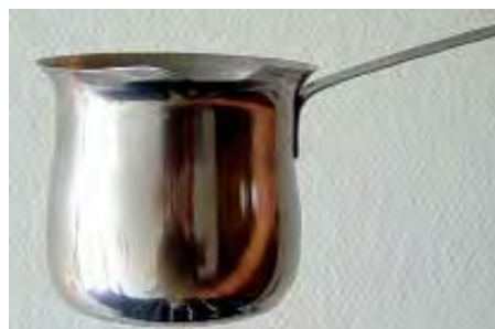
Ferritisk, rustfrit stål kan med fordel anvendes til emner med tyndt gods, store materialeomkostninger og enkel forarbejdning. Denne syrisk frem-stillede kande er af 4016 (AISI 430), et meget anvendt materiale inden for catering. I øvrigt et glimrende eksempel på, at man kan dybtrække ferritisk, rustfrit stål.
