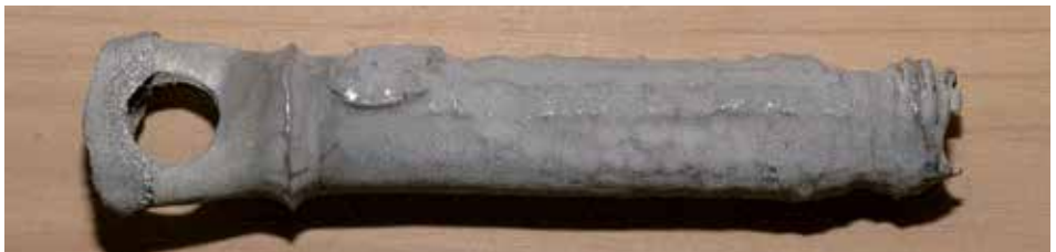
Rustfri bolt (4301) efter et længere ophold i stærk bejdsesyre (salpetersyre-flussyre). Bemærk, at korrosionstab er ganske ensartet og over det hele, og at mængden af tabt metal er ganske stor. Trods det imponerende materialetab er der endnu ikke sket gennemtæring.
